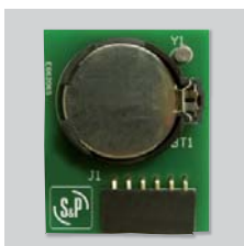
TIMER RTC ECOWATT Модуль электронного таймера.
